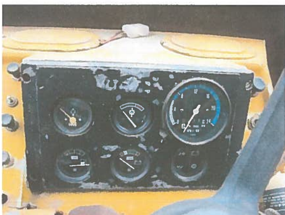
FOTO 03: Detalhe do painel com marcação do horímetro
